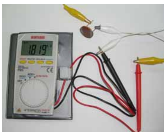
図 マルチメータによる抵抗の計測
